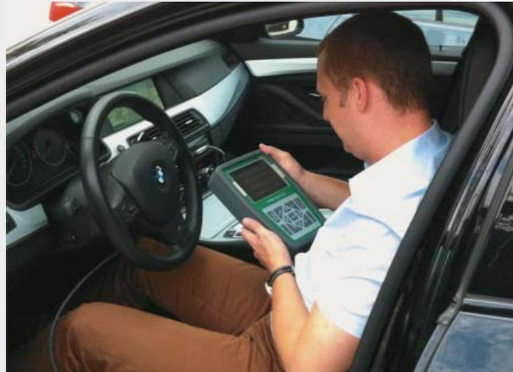
Auswerten der Motordaten eines Start-Stopp Fahrzeuges
