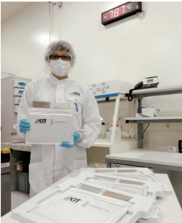
Dank des Trockenraums mit einem Taupunkt von fast  $-80\text{ }^{\circ}\text{C}$  lassen sich hochwertige Batterien zusammenbauen. (Bild: KIT)
