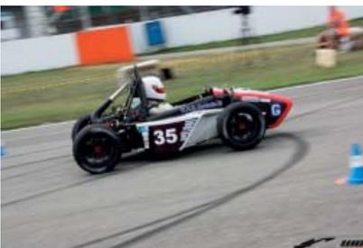
Weiteren wurde auf diese Art und Weise eine schnelle Integration des neuen Antriebsstrangs ermöglicht. Die neugegründete Abteilung „elektrischer Antrieb“ befasste sich intensiv mit den Möglichkeiten dieser alternativen Antriebsart. Man entschied sich für zwei Motoren, die jeweils ein Hinterrad antreiben. Die Energie liefert ein Lithium-Ionen-Batteriepaket.
