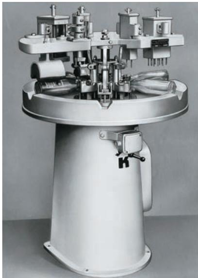
Vor 60 Jahren kamen zur Etikettierung von Getränkeflaschen ausschließlich halbautomatisch arbeitende Tellermaschinen wie die Krones „Piccolo“ zum Einsatz. Der Leistungsbereich lag zwischen 1.000 und 2.100 Flaschen pro Stunde.
