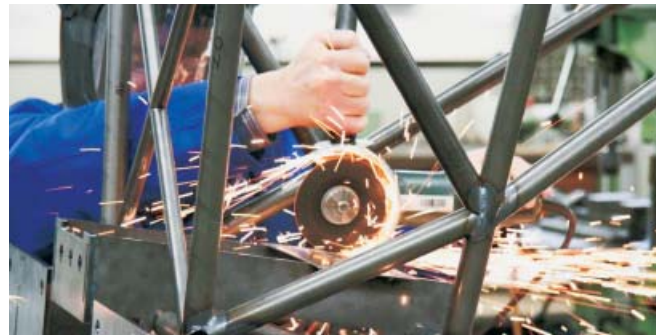
Die Herstellung des Rahmens für ein Fahrzeug des KA-RaceIng Team
