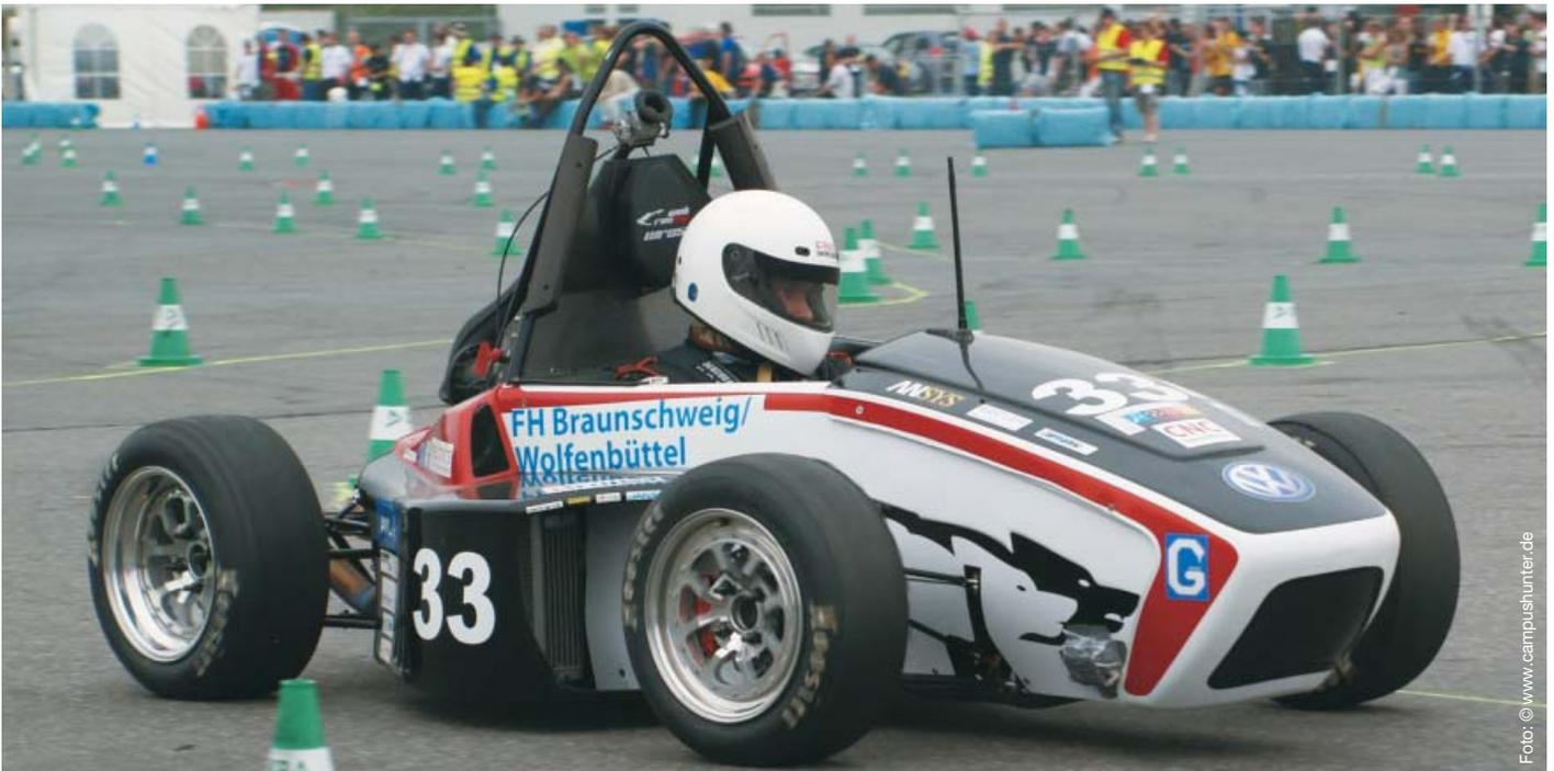
problematischen Situationen werden einzelne Systeme ausgeschaltet - eben wie bei einem Sicherungskasten, nur hier elektronisch gesteuert. Im Bereich Chassis konnten verfahrenstechnisch einige Dinge ändern. So wurde die Außenhaut im Vakuuminfusionsverfahren hergestellt und anschließend mit Folien beklebt anstatt diese zu lackieren.
