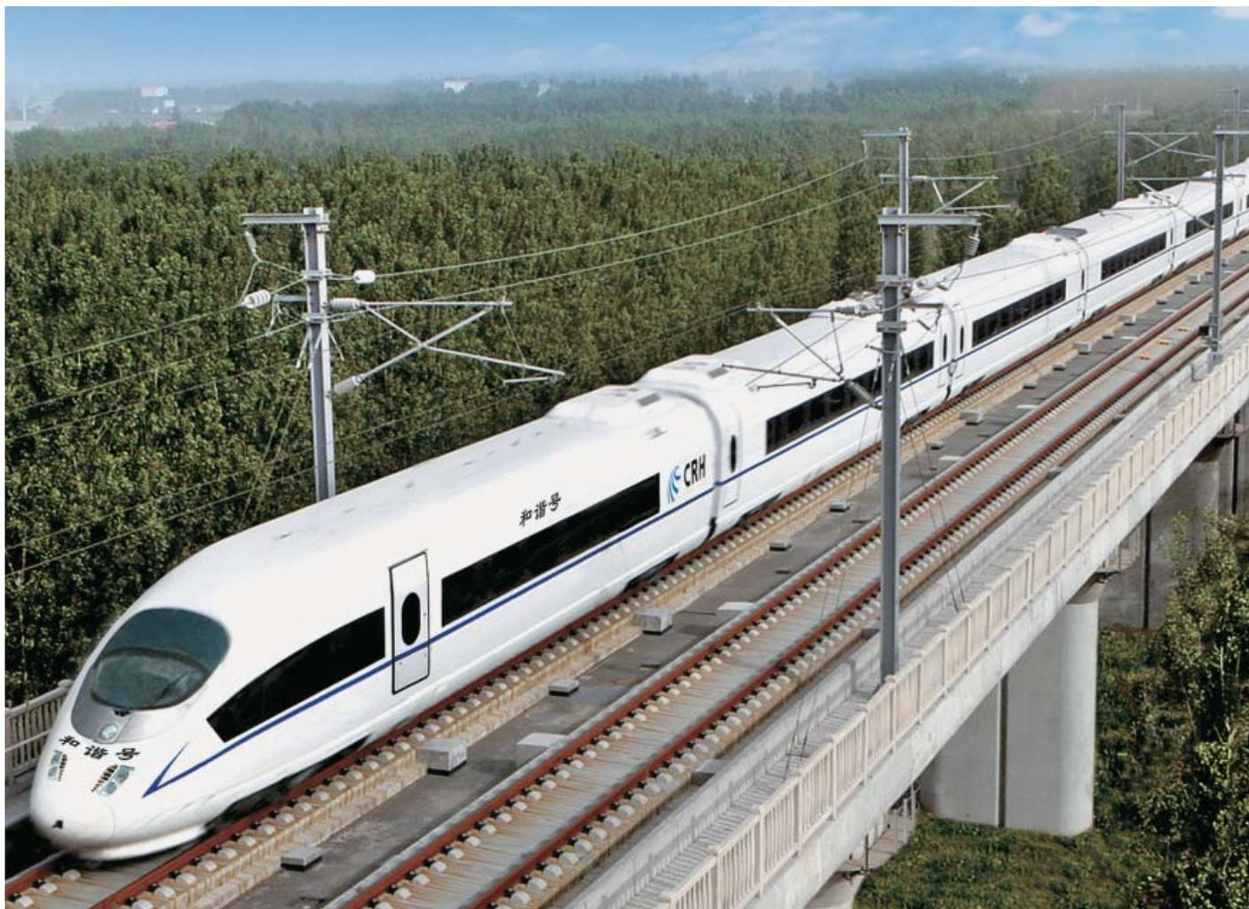
Rechtzeitig zu den Olympischen Spielen 2008 sorgte die Feste Fahrbahn Bögl dafür, dass auch bei Geschwindigkeiten bis zu 350 km/h Bahnfahren auf der 115 km langen, zweigleisigen Strecke mit höchstem Komfort zu genießen ist.
