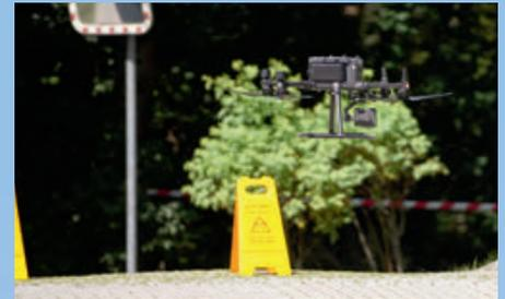
**Zum Einsatz kam auch eine DJI-Drohne mit LiDAR Messgeräten zur Umgebungserfassung der aeroDCS GmbH.**
