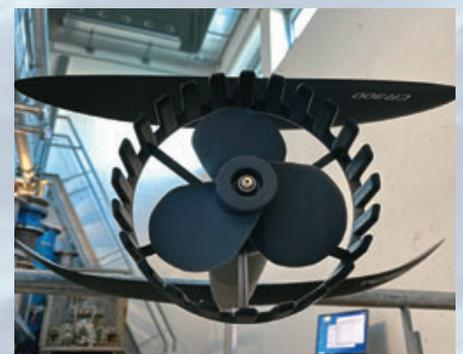
IFAS-Propeller aus dem 3D-Drucker.
