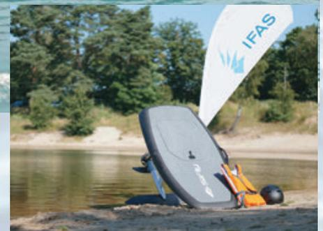
Die Kombination aus elektrischem Antrieb und Tragflächen ermöglicht hohe Geschwindigkeiten (bis zu 45 km/h) und erhebliche Auftriebskräfte, sodass das Board einen Schwebезustand über dem Wasser erreicht.
