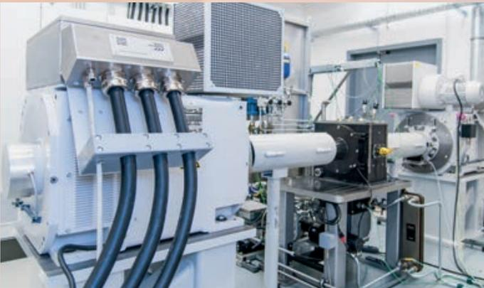
**Auf den über 200 hochmodernen Prüfständen bei ATESTEO werden Getriebe, Antriebsstrang sowie einzelne Komponenten auf Belastbarkeit, Vibration, Lautstärke sowie Verschleiß, Hitze und Kälte getestet.**
