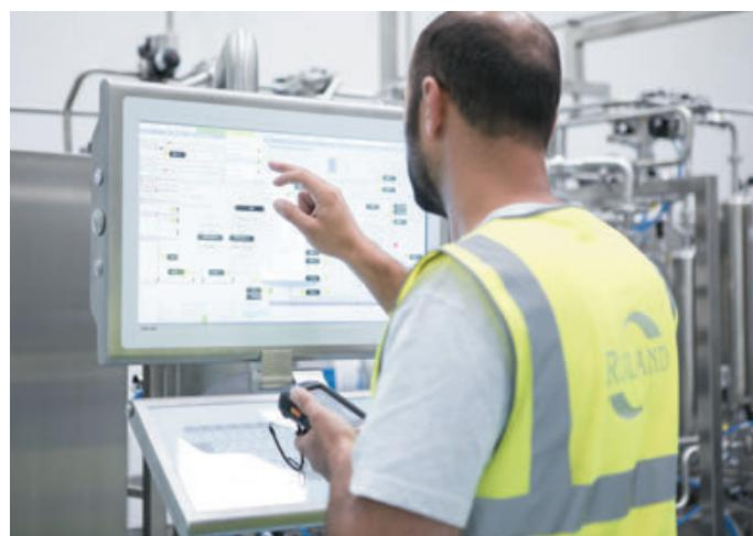
Unsere Anlagenautomation ist so individuell wie unsere Anlagen. Zusätzlich zur SPS-Steuerung mit Siemens oder Rockwell und der WinCC-Visualisierung haben wir eine eigene Softwarelösung für Rezeptursteuerung, Rohstoffverwaltung und Tanklagerhandlung. Das Ruland Process Management System erlaubt eine vollständige Integration in unterschiedliche Automationslösungen, flexible Bedienung an PCs oder Mobilgeräten sowie eine anpassbare Kopplung an vorhandene ERP-Systeme.
