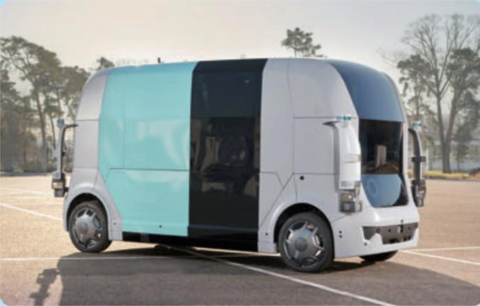
rung auch alle Räder um 90° einlenken kann und so ebenfalls leicht seitlich in kleinste Parklücken passt. Entsprechend der intendierten Nutzung von Fahrzeugen können individuelle Kabinen auf die Fahrplattform gesetzt werden. Dieses Baukastenprinzip erlaubt eine maximale Flexibilität bei der Innenraumgestaltung bei minimalem Entwicklungsaufwand für eine zukünftige Serienproduktion.
