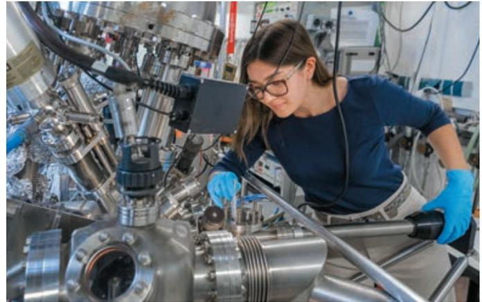
**Arbeit im Labor: Nereida Abad-Yang lädt eine neue Probe in die Schleuse, um sie später im Mikroskop zu untersuchen.**
