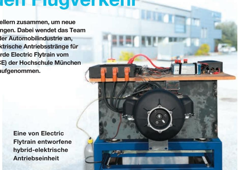
Eine von Electric Flytrain entworfene hybrid-elektrische Antriebseinheit
