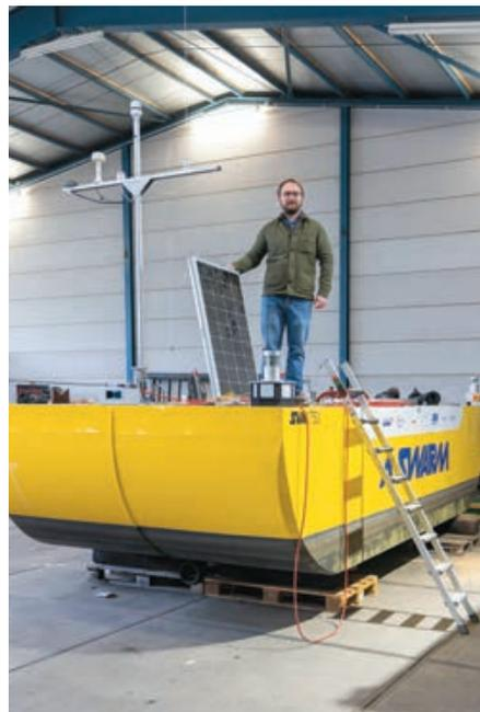
**Betrieben mit Elektromotor und Sonnenenergie, ausgestattet mit GPS, Laserradar und Funk: Tim Holzki präsentiert einen A-SWARM-Prototypen, der noch gut gesichert in einer Lagerhalle steht.**
