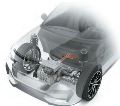
Das hochintegrierte und kompakte Gesamtsystem der 4in1-E-Achse benötigt deutlich weniger Bauraum als nicht integrierte Lösungen.
