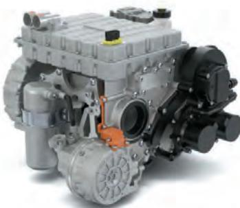
Mit der 4in1-E-Achse integriert Schaeffler neben Elektromotor, Leistungselektronik und Getriebe auch das Thermomanagement in den Achsantrieb.
