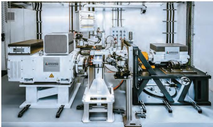
Auf den über 180 hochmodernen Prüfständen bei ATESTEO werden Getriebe, Antriebsstrang sowie einzelne Komponenten auf Belastbarkeit, Vibration, Lautstärke sowie Verschleiß, Hitze und Kälte getestet.
