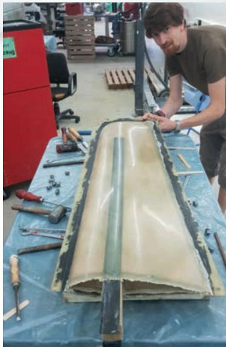
An Tag eins und zwei nahmen wir uns zunächst etwas kleinere und leichtere Bauteile vor. So wurden an diesen Tagen zwei Stege in C-Form laminiert, welche später zusammengeklebt wurden und somit einen Steg in Doppel-T-Form ergaben.
