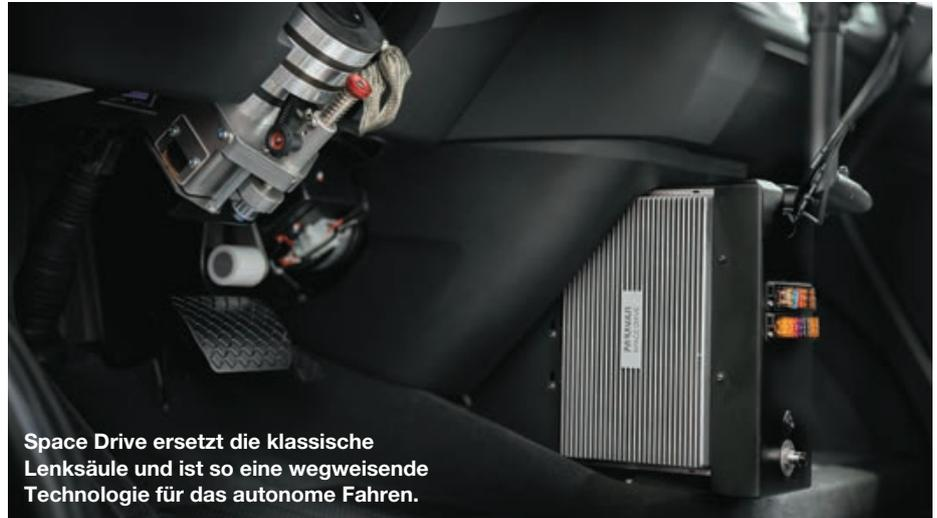
Space Drive ersetzt die klassische Lenksäule und ist so eine wegweisende Technologie für das autonome Fahren.
