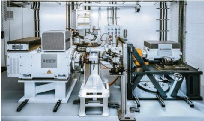
Auf den über 150 hochmodernen Prüfständen bei ATESTEO werden Getriebe, Antriebsstrang sowie einzelne Komponenten auf Belastbarkeit, Vibration, Lautstärke sowie Verschleiß, Hitze und Kälte getestet.
