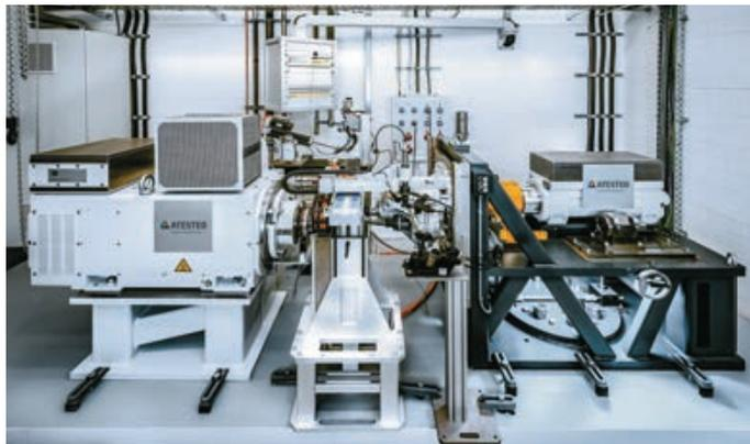
Auf den über 150 hochmodernen Prüfständen bei ATESTEO werden Getriebe, Antriebsstrang sowie einzelne Komponenten auf Belastbarkeit, Vibration, Lautstärke sowie Verschleiß, Hitze und Kälte getestet.
