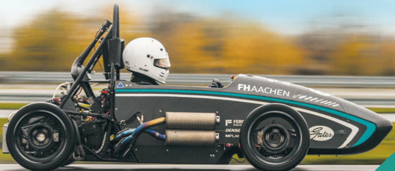
gefunden. Die Geometrie des Heckrahmens wurde leicht geändert, was uns ermöglicht, nun an einigen Stellen Rohre mit gerade einmal 0,7 mm Wandstärke einzusetzen.
