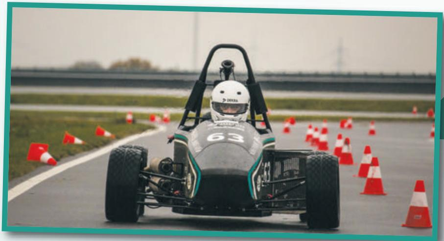
Auch die Position der Spurstange wurde verändert um das Fahrverhalten in Kurven, sowie auf geraden Teilen der Strecke, zu stabilisieren.
