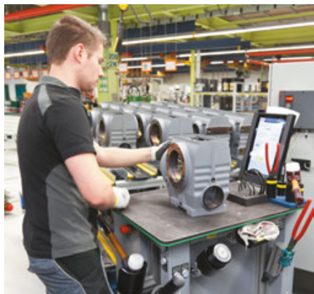
Der Montageassistent wird mit der Übergabe der Auftragsdaten auf das Tablet zum Cyber-Physical-System und unterstützt den Werker bei der Leistungserbringung.
