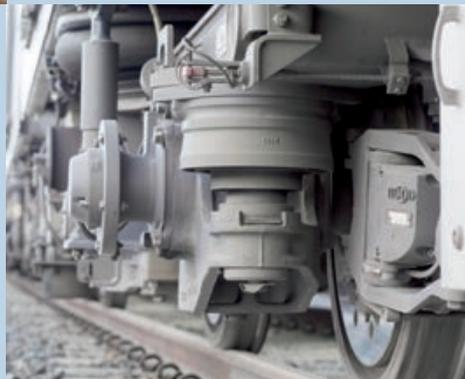
Pneumatische Steuerungskomponenten funktionieren in einem Temperaturbereich von -60°C bis +70°C – und das 10 Jahre wartungsfrei.
