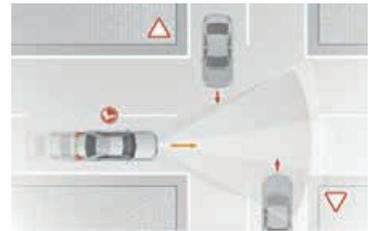
**BAS PLUS mit Kreuzungs-Assistent: Bremsunterstützung auch bei Querverkehr**
