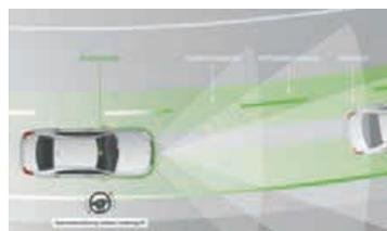
**DISTRONIC PLUS mit Lenkassistent und Stop and Go Pilot**
