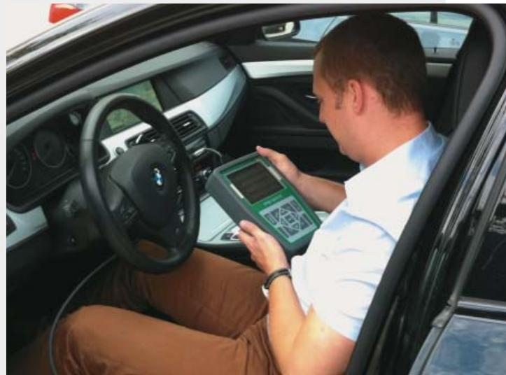
Auswerten der Motordaten eines Start-Stopp Fahrzeuges
