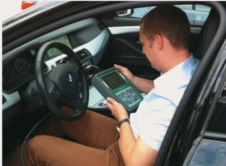
Auswerten der Motordaten eines Start-Stopp Fahrzeuges
