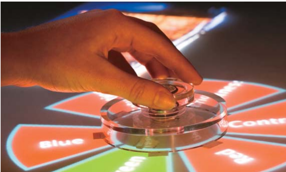
Ein SLAP-Drehregler erleichtert die Dateneingabe
