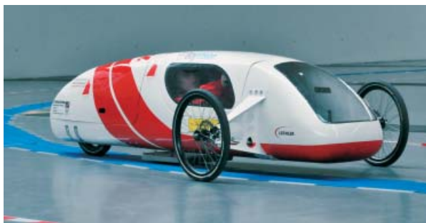
Studierende der Hochschule Karlsruhe – Technik und Wirtschaft konstruierten mit dem E-Quickie ein Elektromobil mit drahtloser Energieübertragung
