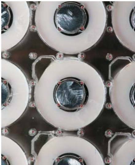
Glasfasern (rot) leiten das Bild um das Feld von Elektromagneten unter dem Madgets-Tisch
