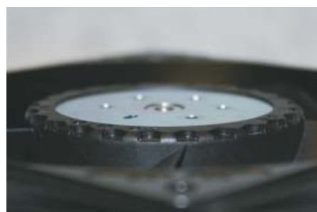
Lüfter für die Kühlung des Akkumulatorpacks
