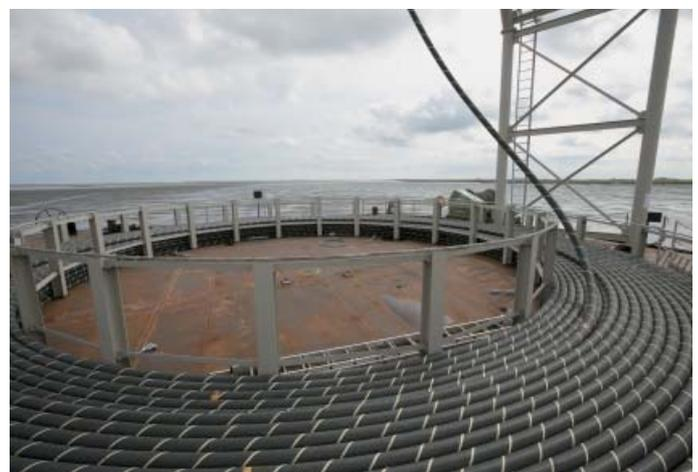
Das Verlegeschiff im Wattenmeer spult das 5 km lange Kabel von einem Drehteller auf Deck.
