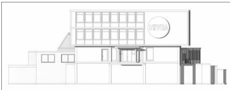
Aus der BIM-Datenbank können Ansichten „auf Knopfdruck“ erzeugt werden.
