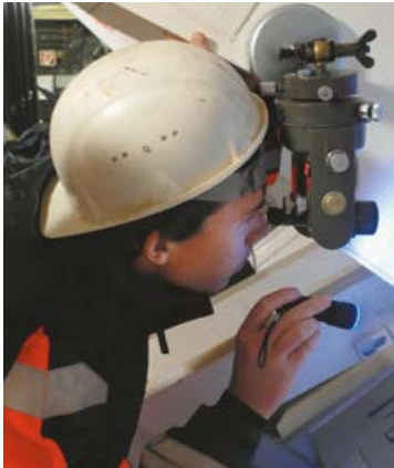
Master-Student Christoph Himmelreich prüft mit einem Hängetheodolit, ob der Streb gerade verläuft
