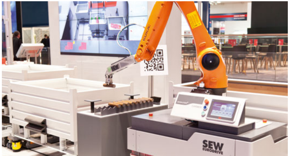
Der Handlingsassistent fährt selbstständig von einem Einsatzort zum nächsten und liest sein Arbeitsprogramm, sowie die Positionierung über einen QR-Code aus.
