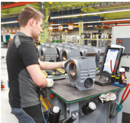
Der Montagessistent wird mit der Übergabe der Auftragsdaten auf das Tablet zum Cyber-Physical-System und unterstützt den Werker bei der Leistungserbringung.
