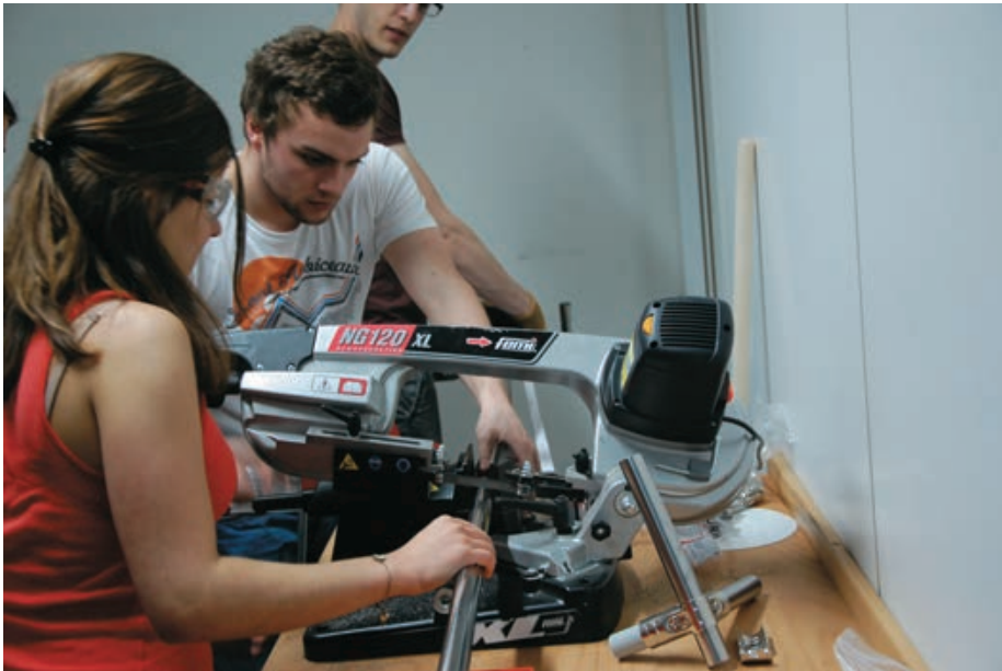
Arbeit in der Werkstatt der Lernfabrik zum Zuschritt der Rohre des BeeWaTec Rohrstecksystems
