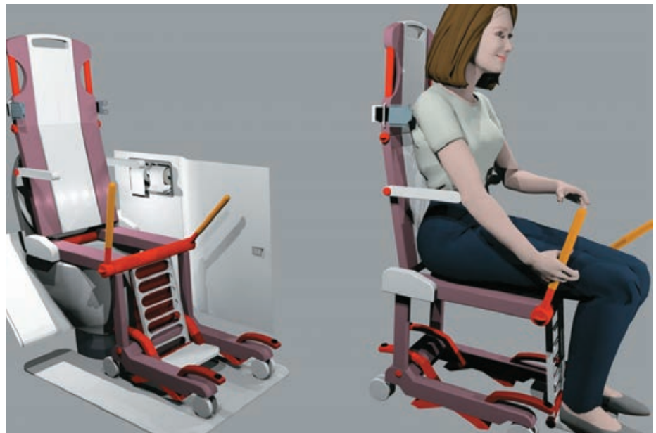
Flugzeugspezifischer bordeigener Rollstuhl, der in den Lavatories das Umsetzen des behinderten Passagiers vermeidet
