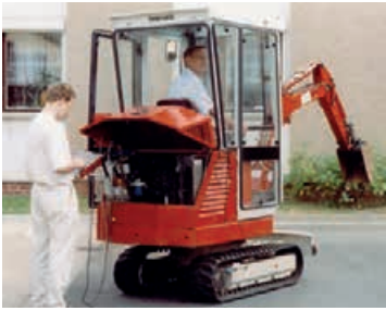
Bild 3: Hydraulikdiagnose an einem Minibagger
